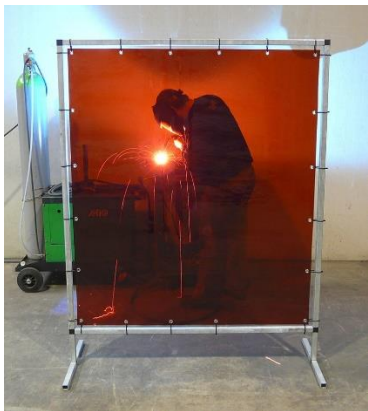
Figure 1: Un soudeur travaillant derrière un écran de soudage.
