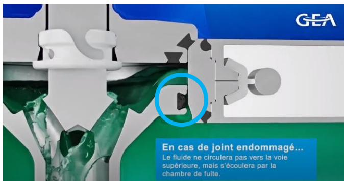
FIGURE 2 : EXTRAIT VIDÉO DE GEA - EXEMPLE DE FUITE AU NIVEAU DU JOINT INFÉRIEUR
